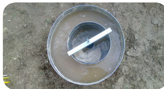
Figure 8 : Mesure de vitesse d'infiltration par la méthode du double cylindre
