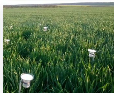
Dispositif de mesure des pesticides et des composés organiques volatils lors de l'expérimentation AgriMultiPol sur le site ICOS de Grignon en 2018. Filtrés utilisés pour mesurer la dose de Chlorothalonil apportée au champ.
