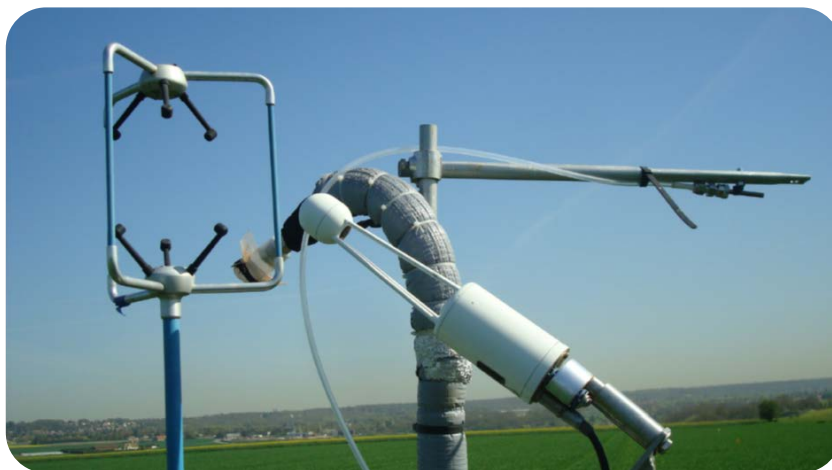
Dispositif déployé pour mesurer les pesticides et les composés organiques volatils lors de l'expérimentation AgriMultiPol sur le site ICOS de Grignon en 2018. Anémomètre ultrasonique (gauche), analyseur de gaz par infrarouge (CO 2 , H 2 O, au 1 er plan), tête de prélèvement pour le PTRMS (tube gris), cartouche de prélèvement pour TD-GC-MS (droite). © C. Decuq
